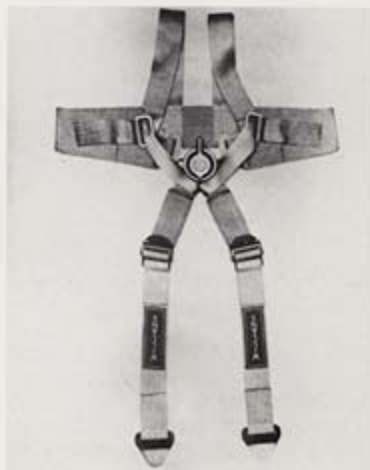
Fig. 1. L'imbragatura a sei punti della Williams è una delle preferite dai piloti di auto da corsa.
